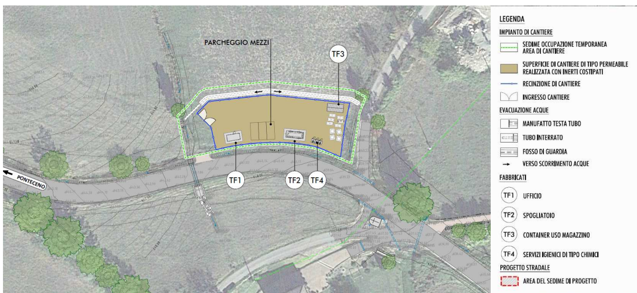
FIGURA 12-7 – LAY-OUT FUNZIONALE DELL'AREA LOGISTICO-OPERATIVA (ESTRATTO DALL'ELAB. PE.04.04)
