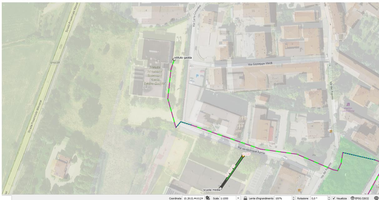
Si segnala la presenza di n.1 cavi da 48 fibre ottiche di proprietà Lepida ScpA posato in monotubo di diam. 50 mm, infrastruttura realizzata mediante lo scavo tradizionale nel cortile dell'Istituto Superiore "Carlo Emilio Gadda", infrastruttura di proprietà del Comune di Langhirano (vedi tratto di colore verde/ viola e blu/verde sopra indicato).
