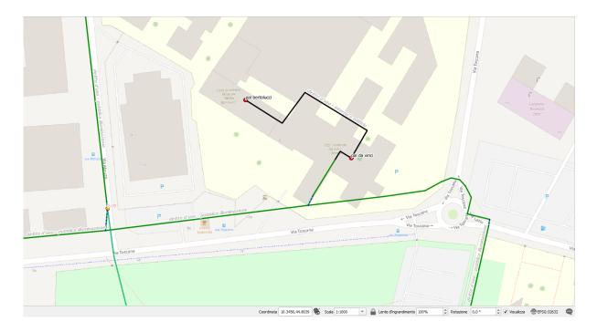
Si segnala la presenza di n.1 cavo da 12 fibre ottiche di proprietà Lepida ScpA posato in monotubo di diam. 50 mm, infrastruttura realizzata mediante scavo tradizionale lungo la via Toscana, infrastruttura di pubblica illuminazione di proprietà del Comune di Parma (vedi tratto di colore verde).
