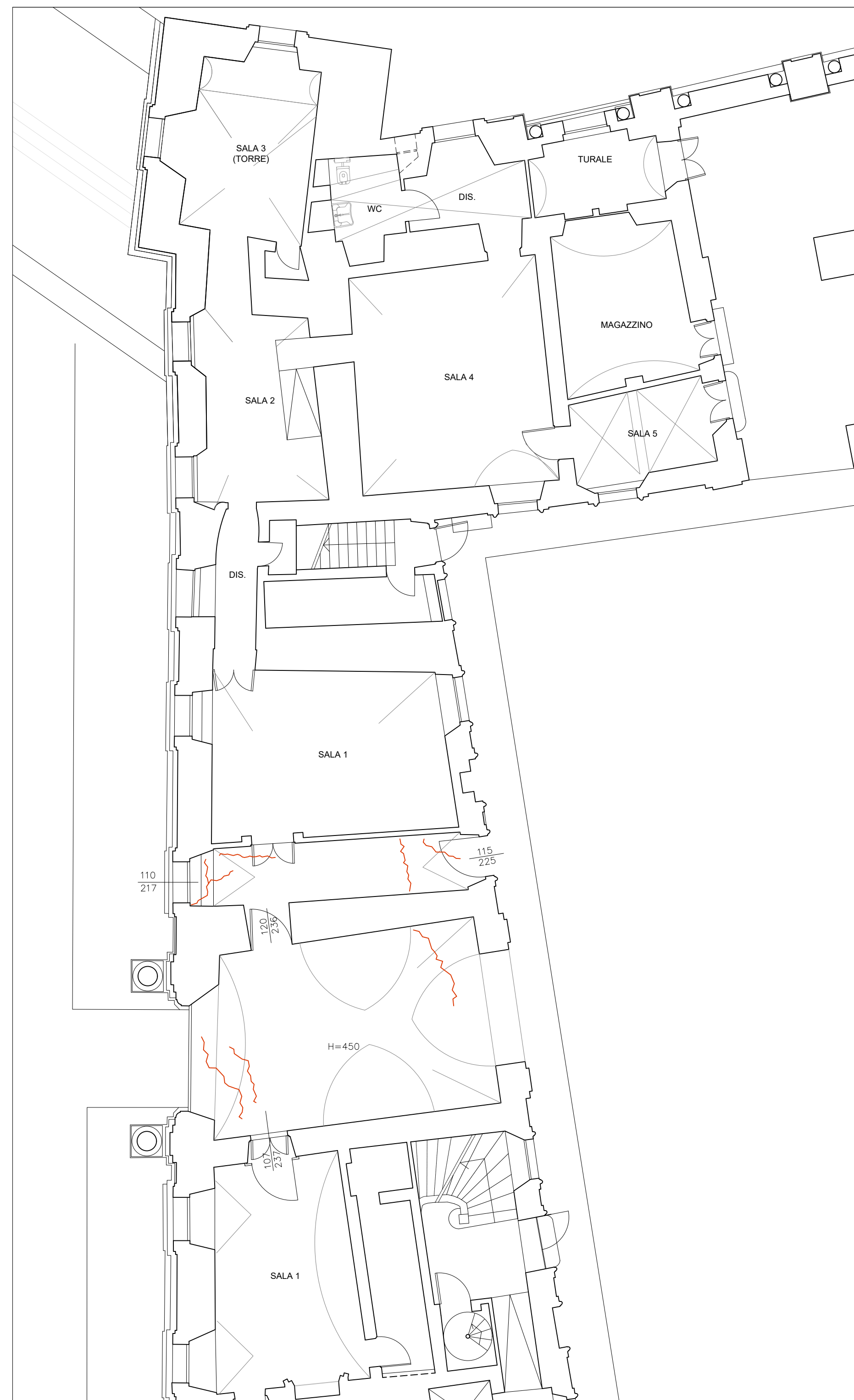
PIANTA PIANO TERRA: quadro fessurativo scala 1:100
