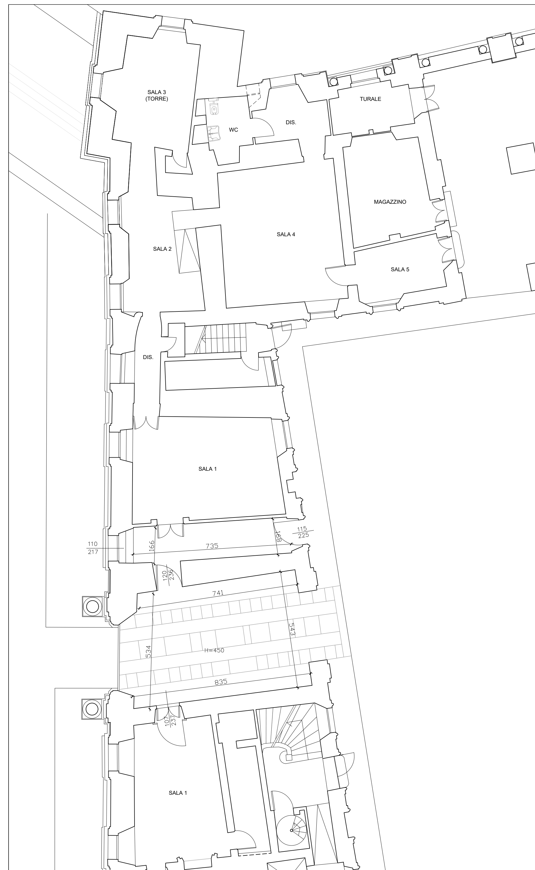
PIANTA PIANO TERRA: rilievo pavimentazioni scala 1:100
