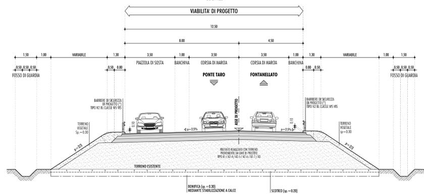
**SEZIONE TIPO IN ROTATORIA**
