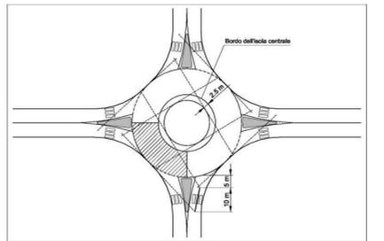
Figura 12: Campi di visibilità in incrocio a rotatoria
