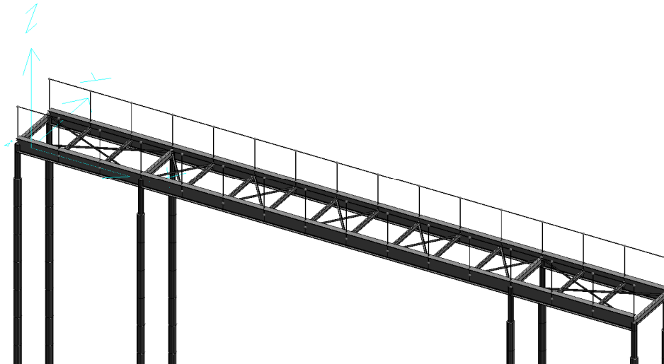
Figura 6 – Particolare modellazione dell'impalcato
