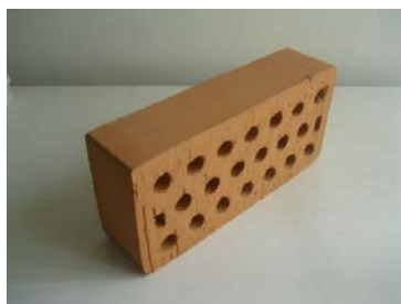
Figura 2 Esempio di mattone semipieno 15\% < \phi \leq 45\% in laterizio per murature portanti
